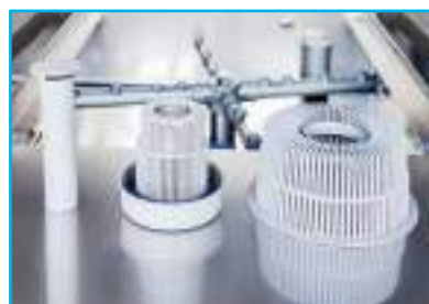
Salida del agua en forma de hoja para mejorar el aclarado.
