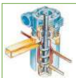
Reductor colocado en la parte superior del evaporador
