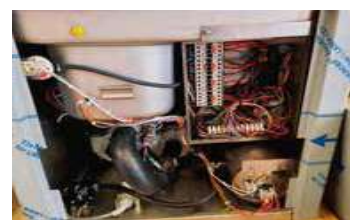
2 Bombas lavado: 1HP independientes para brazo superior e inferior, máx. rendimiento y fácil acceso
