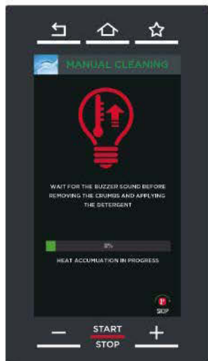
A temperatura demasiado baja: espere al calentamiento
