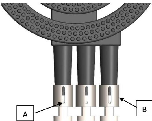
Para obtener el máximo rendimiento en la combustión del quemador, la llama debe ser de color azul oscuro, sin puntas amarillas demasiado marcadas y estables en su base. Los quemadores salen de fábrica ya regulados de acuerdo con las características del gas a utilizar y su presión (categoría del aparato). Por lo tanto, no se debe intervenir en dicha regulación, a no ser que adapte a otro
