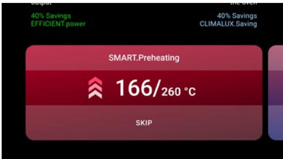
UNOX te recomienda utilizar SMART.Preheating, un pre calentamiento automático que ajusta de manera autónoma el tiempo y la temperatura de pre calentamiento; también tiene en cuenta la pérdida de calor al abrir la puerta y se activa al pasar de una fase a otra, adaptando la cámara de cocción a los parámetros de la nueva fase.
